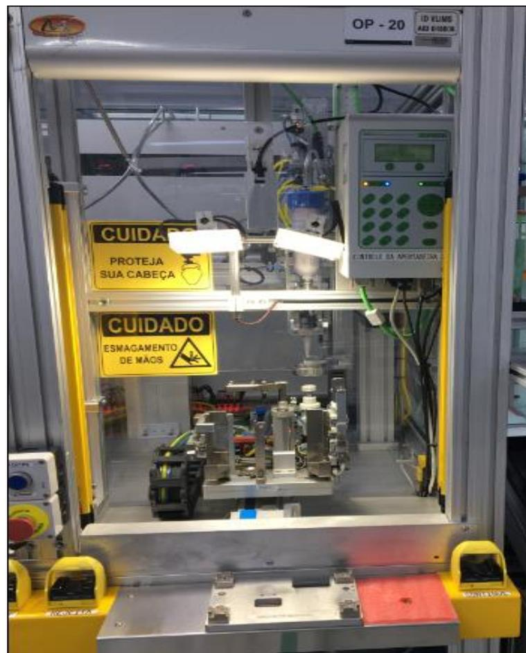
A figura 4.1 acima mostra o gabinete onde a empresa faz o parafusamento da placa. De modo resumido, explicamos o procedimento: a peça automotiva, que compõe o painel dos veículos que a empresa fabrica, é basicamente feita de componentes eletrônicos tais como microprocessador, display, elementos lógicos, componentes resistivos, capacitivos, transistores e etc.
