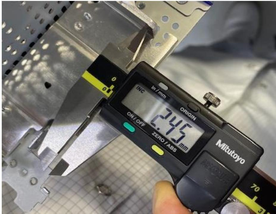
Comparando o que é apresentado pelas figuras 4.4.a e 4.4.b com as especificações mostradas na figura 4.2.b, observamos que o furo, por onde é feito o parafusamento da peça, foi fabricado fora das margens de tolerância superior ( $2,2 + 0,12$  mm). Assim ficou comprovado que o defeito na peça é uma das causas raízes do problema.
