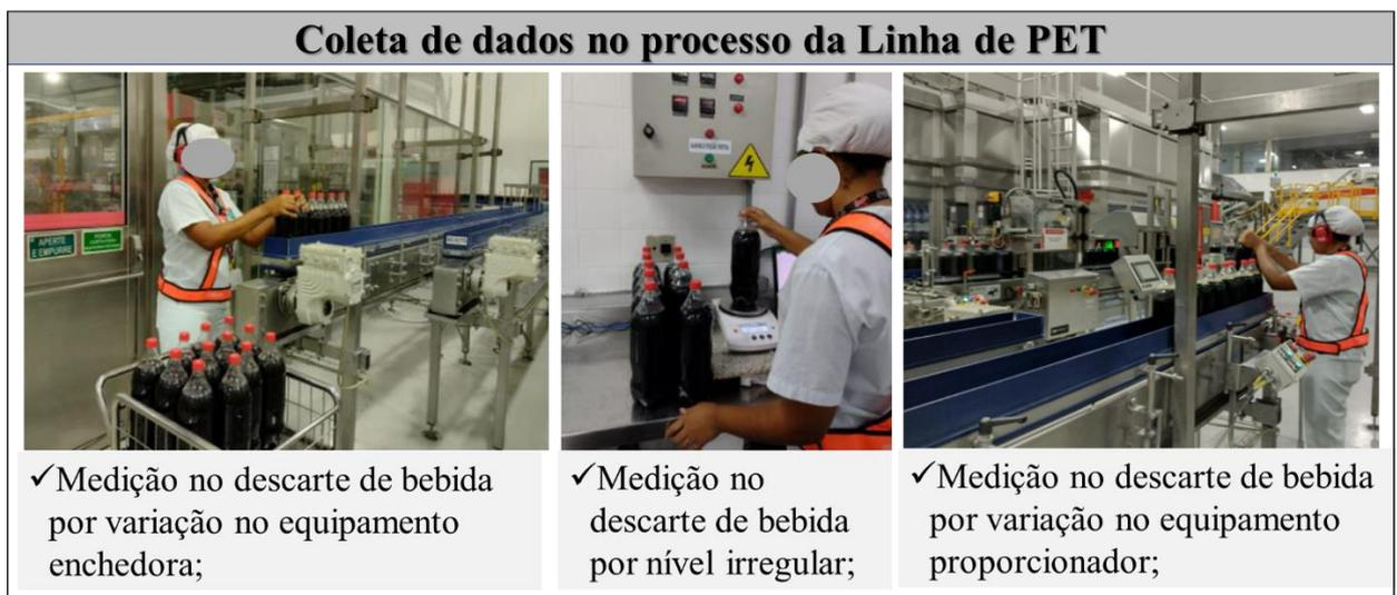
Após as coletas de dados nos defeitos para medições dos Indicadores M2 e M3, é possível examinar no Gráfico de Pareto um alto índice de defeitos devido nível irregular representando 72% das amostras dos defeitos coletados, equivalente a 2.160 amostras, que geram uma perda significativa no resultado financeiro da empresa conforme ilustração da Figura 50.
