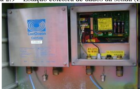
Figura 2.9 – Estação coletora de dados da sonda ( Logger )
