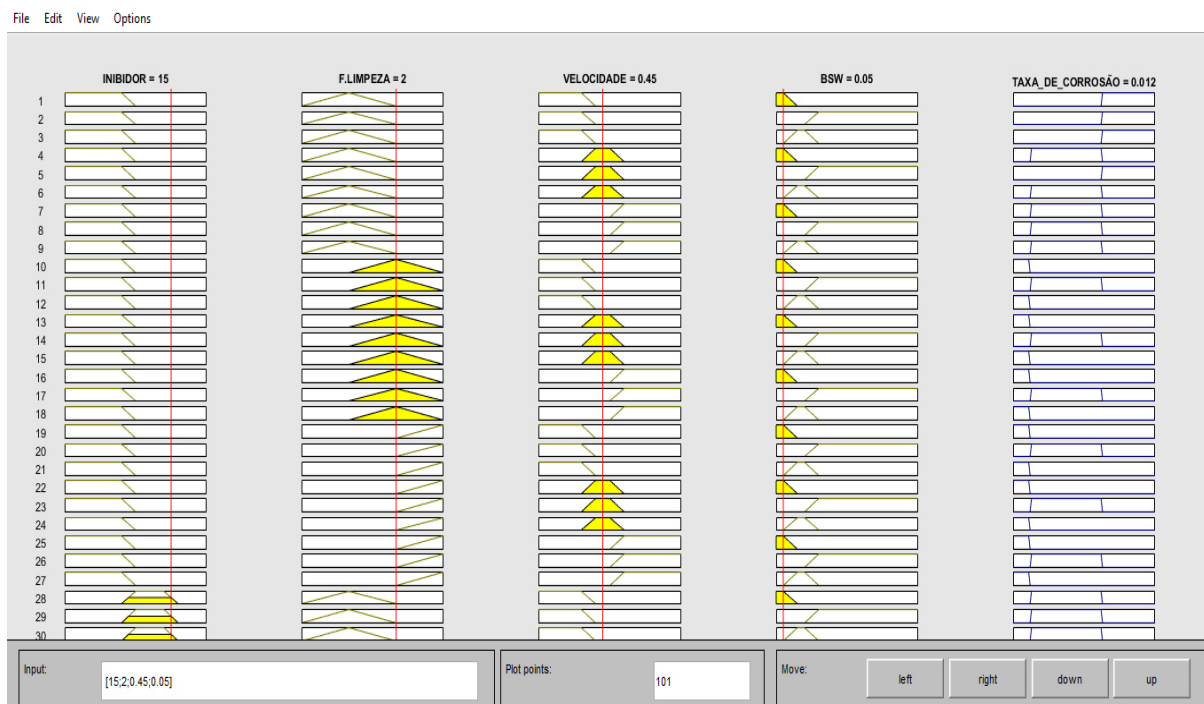
Figura 4.1 – Algumas das regras do modelo Fuzzy e resultado para os parâmetros da campanha 1 – taxa de corrosão
