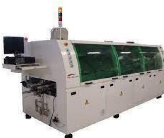
A máquina não é dedicada isso significa que outros produtos além do CR BETA e isso torna necessária a utilização de pallets de soldagem (Figura 8) com capacidade de 7 placas por pallet, nos quais as placas são encaixadas antes de passarem pela Inserção Manual.
