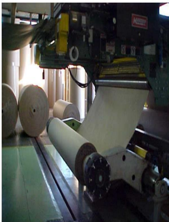
Figura 2.4 – Entrada do Papel na Onduladeira e Processo de Formação da Chapa
