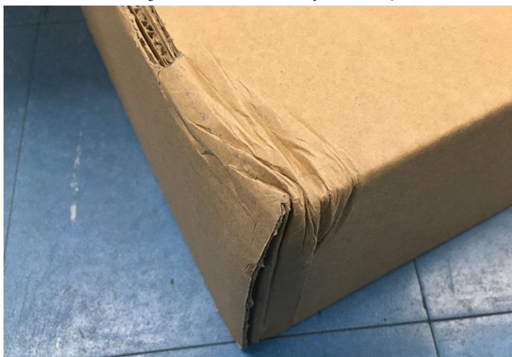
Figura 4.14– Caixa Deformada após Teste de Queda
