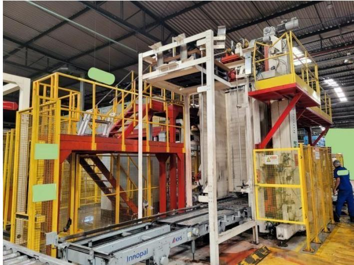
Figura 4.8 - Transportador após despalletizadora.
