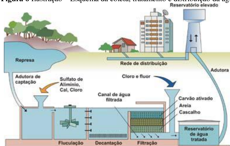
Figura 6 Ilustração – Esquema da coleta, tratamento e distribuição da água
