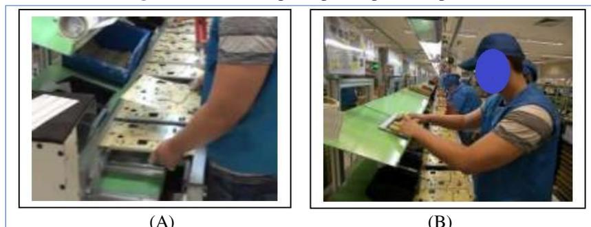
Algumas placas produzidas na linha são depanilizadas (separadas uma das outras) no início da linha, onde o trabalhador faz o desmembramento das placas através de máquina de corte acionada por pedal. Ele pega a placa em carrinho atrás de si, em movimentos de prensão pulpar (conforme Figuras 17A-C), a insere no suporte (Figura 20A), faz seu posicionamento, realizando flexão de braços (Figura 20B) e aciona pedal para que o corte seja realizado (Figura 20C).
