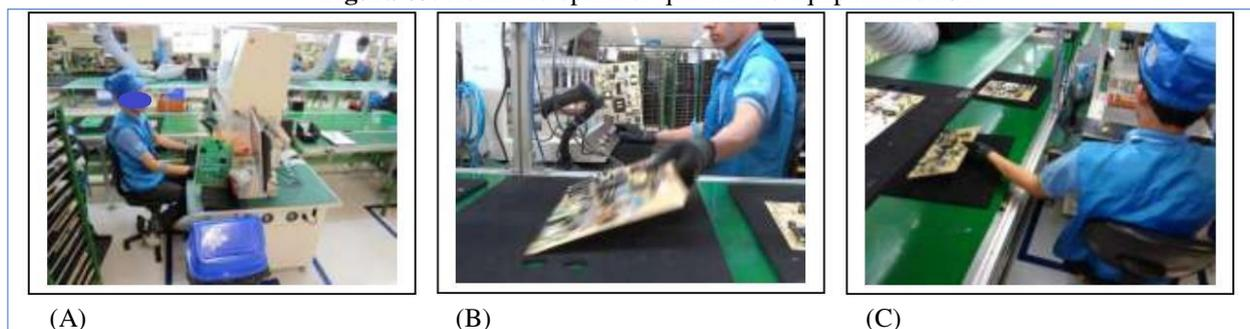
Ele leva a placa até a sua frente e a segura com ambas as mãos (Figura 64A), depois posiciona-a no jig do teste em movimento de flexão dos braços de modo acentuado, e isso ocorre porque o local de deposição está distante da sua área de alcance (Figura 64B). Em seguida ele aciona a botoeira bimanual com leve esforço e o teste é iniciado (Figura 64C).
