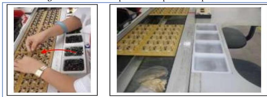
Alinhar balancim com a pistola sobre a área onde a placa estacionará a fim de amenizar as movimentações laterais do conjunto balancim + pistola sobre trilho suspenso (Figura 29).
