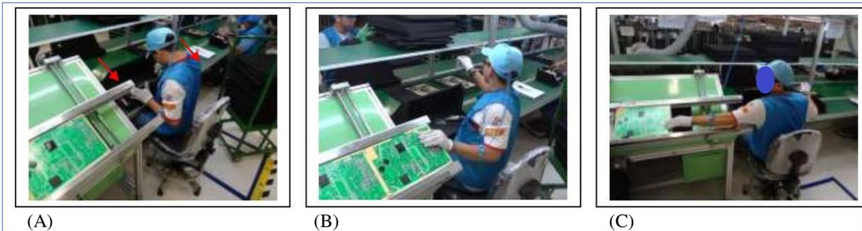
Em seguida ele posiciona a placa na mesa (Figura 56A) e dá início ao processo de corte dos terminais (Figura 56B). Para isso ele faz uso de alicate pneumático que não exige esforço da mão para cortar e o gatilho de acionamento é bem leve. Há, porém, sustentação do peso do mesmo em postura de preensão palmar e movimento flexão de punho (Figura 56C).
