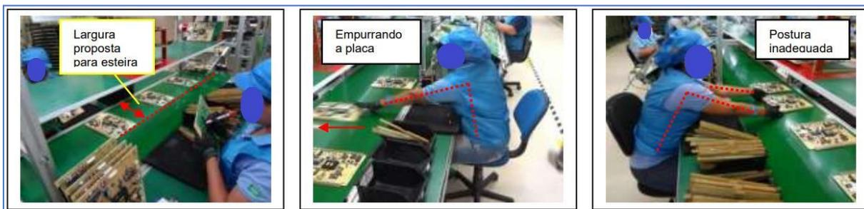
Instalar um recipiente de cada lado da trabalhadora para depositar as longarinas. Ao retirar a longarina do lado esquerdo da placa ela a colocaria no recipiente do lado esquerdo sendo igualmente para o lado direito. Atualmente ela faz movimento de adução do braço em razão de existir recipiente só de um lado (Figura 43).
