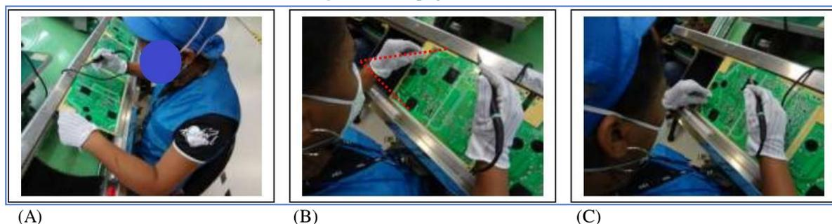
O uso do ferro de solda é feito somente se necessário, quando o trabalhador identifica alguma falha. São realizados movimentos de pinçamento pulpar com a mão direita com leve esforço enquanto a mão direita direciona o fio de estanho ou segura a placa (Figuras 50A e 50B). De forma geral, os esforços envolvidos são leves.
