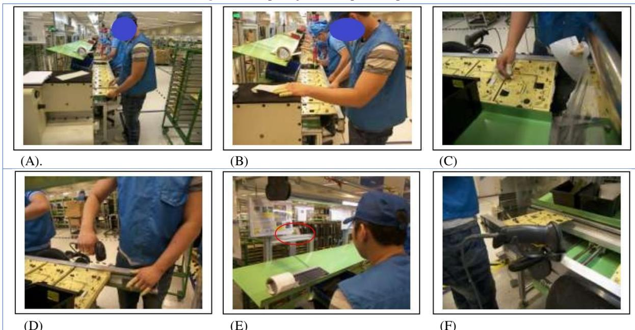
O trabalhador finaliza seu ciclo de trabalho empurrando a placa com a mão esquerda para que o próximo posto realize suas atividades. Neste momento ele reinicia seu ciclo de trabalho conforme Figuras 17A a 19A. Para inclusão de novas etiquetas no sistema, o trabalhador utiliza
