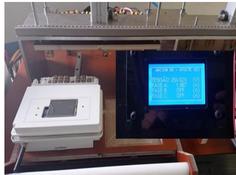
Figura 4.78 - Teste de Controle de tensão e corrente da Fase A.
