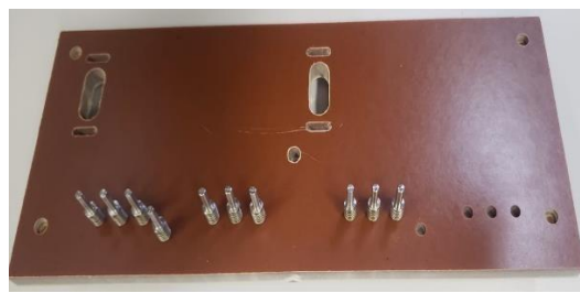
Figura 4.64 - Montagem do suporte da base de agulhas.
