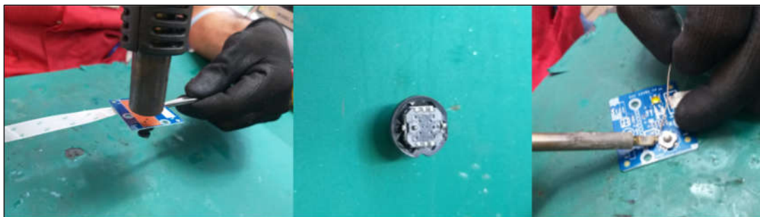
Figura 4.7 - Substituição do conjunto chave- joystick .
