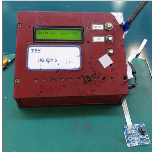
Figura 4.6 - Testagem do conjunto joystick -PCBA-cabo montado.
