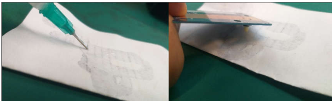
Figura 4.12 - Inserção de cola com uso de papel na dosagem.
