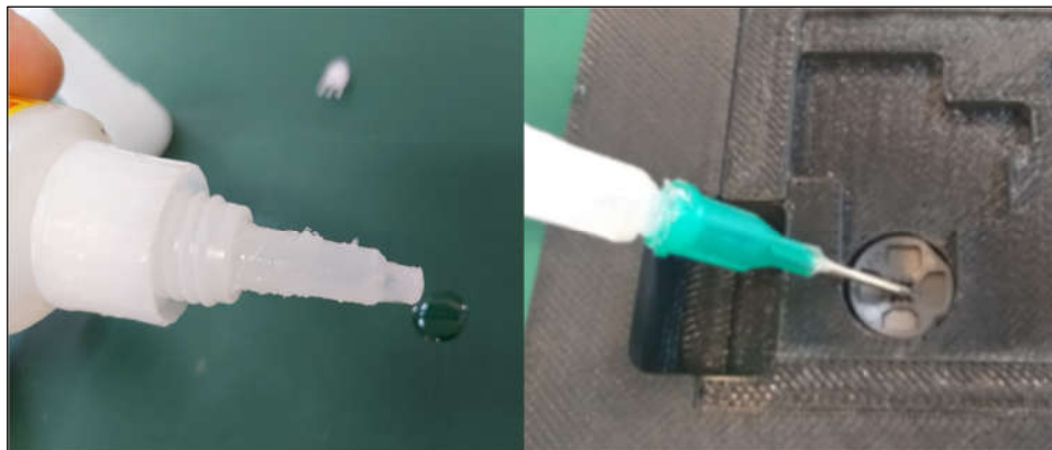
Figura 4.10 - 1 Redução da ponta do dosador.
