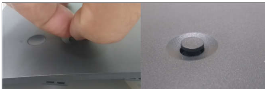
Figura 4.18 - Simulação de remoção do joystick no gabinete montado.
