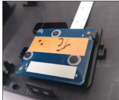
Figura 4.17 - Conjunto montado no gabinete do produto.
