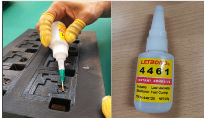
Figura 4.2 - Processo de adesivagem com cola Letbond 4461.
