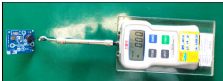
Figura 3.6 - Medição da força de remoção do botão joystick da placa.
